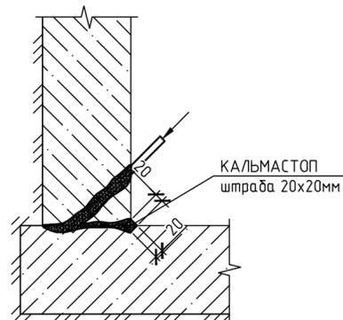
Гидроизоляция примыкания стена / плита основания и водонесущих трещин:
