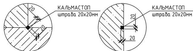
Гидроизоляция примыкания стена-плита основания при наличии водонесущих трещин не зависимо от ширины раскрытия
